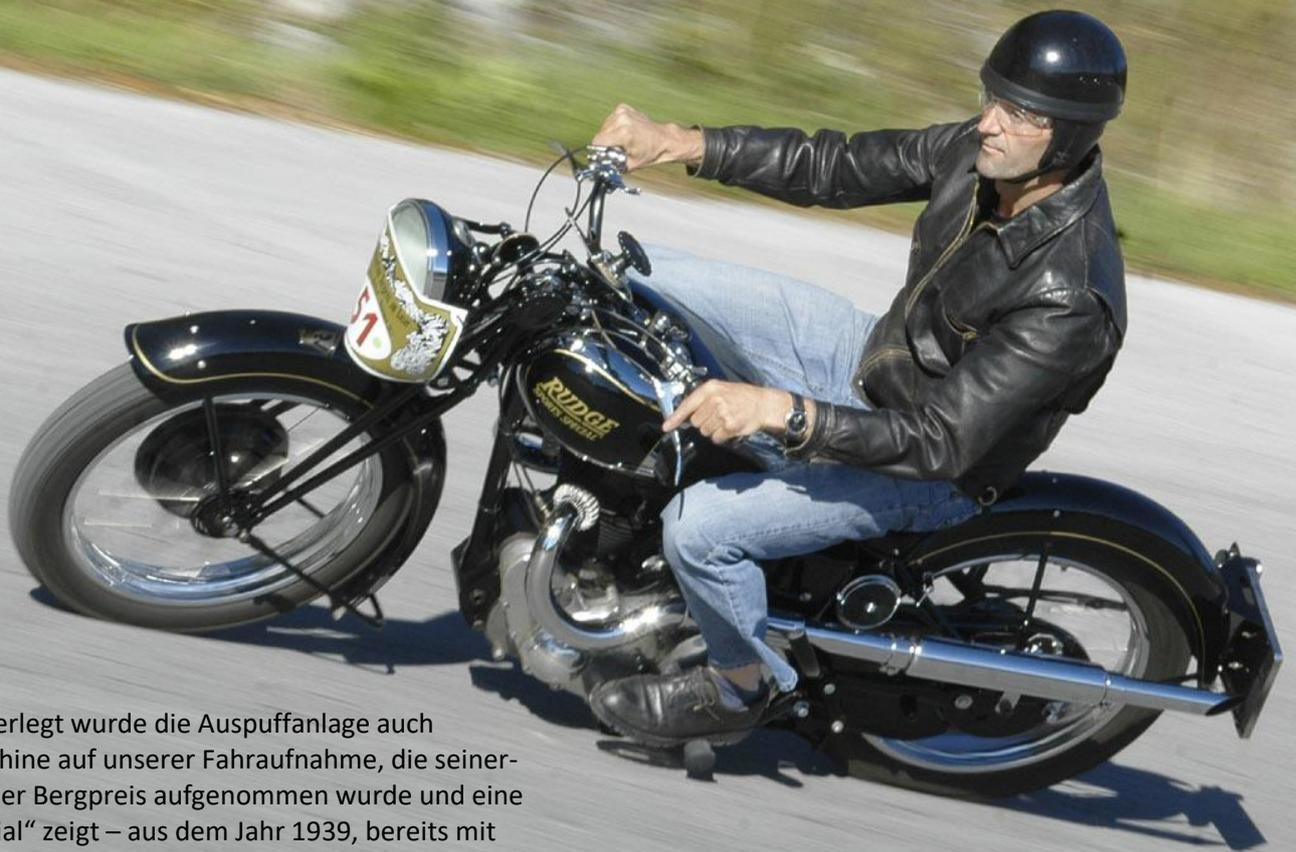
Nach oben verlegt wurde die Auspuffanlage auch bei der Maschine auf unserer Fahraufnahme, die seinerzeit beim Loser Bergpreis aufgenommen wurde und eine „Sports Special“ zeigt – aus dem Jahr 1939, bereits mit gekapselten Ventilen.
